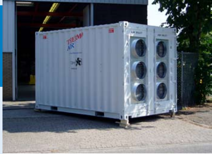
Omgebouwde zeecontainers voor 350 kW mobiel koelvermogen
